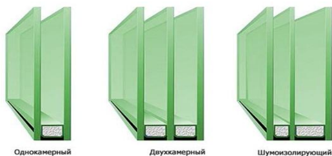
Рисунок 6 - Отличия асимметричного шумоизолирующего стеклопакета от обычных аналогов
